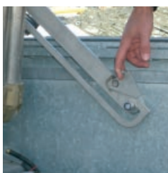
4. Lågstøtte med sikringspal.
